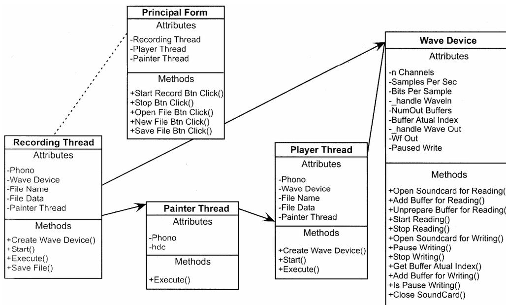
Fig. 5—UML diagram of the software’s main classes
