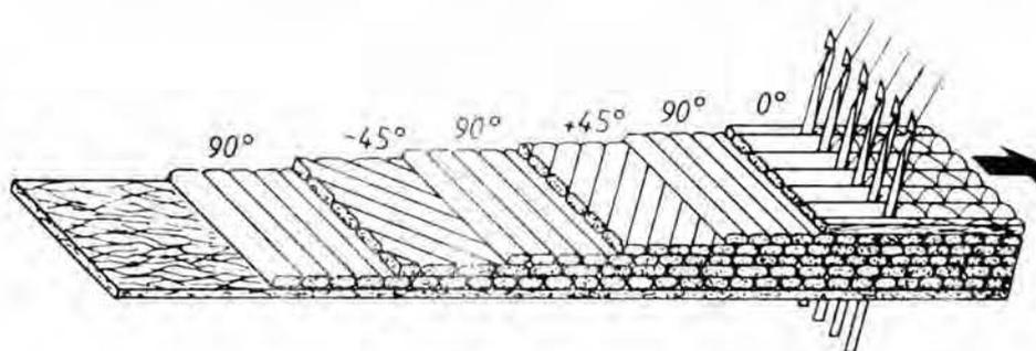
Fig. 7—Multiaxial DOS (LIBA Maschinenfabrik GmbH): 5 Weft yarn stations and warp yarn
